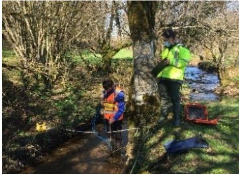
Prélèvement d'eau et mesure ponctuelle des débits au droit d'une station « qualité », action SUIVI-2 – Pays de Salars
