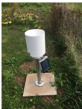
Photos n°10 et 11 : Système local de pré-alerte (pluviomètre) et d'alerte (détecteur de mise en charge du chenal de crue) mis en place en 2019 sur la commune de Bertholène (Lugagnac) / source SMBV2A
