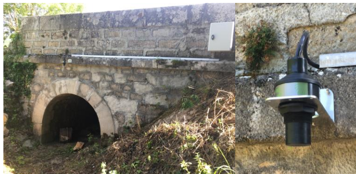
Photos n°10 et 11 : Système local de pré-alerte (pluviomètre) et d'alerte (détecteur de mise en charge du chenal de crue) mis en place en 2019 sur la commune de Bertholène (Lugagnac) / source SMBV2A
