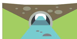
Buse circulaire enterrée au 1/3
