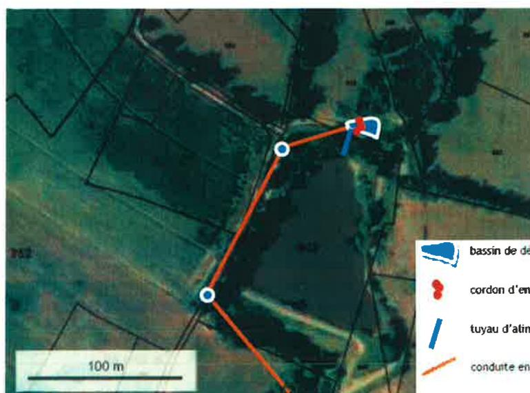
*Illustration n°3 : plan des travaux d'optimisation environnementale envisagés sur un plan d'eau du bassin de la Roumanelle à La Fouillade dans le cadre de l'action B2c (2019)*
