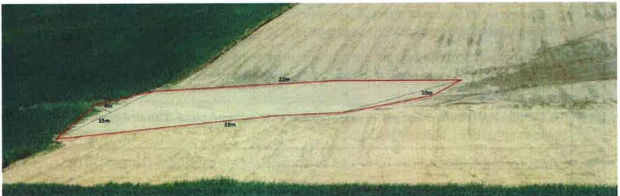
Photo n°3 : illustration d'une mesure de volume de terre sédimenté sur une parcelle du bassin de la Serène
